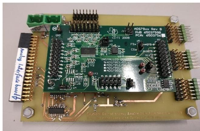
Figura 4.10 Kit de desarrollo ADS7953EVM-PDK con placa de interconexión para Zedboard y etapa de adaptación.
