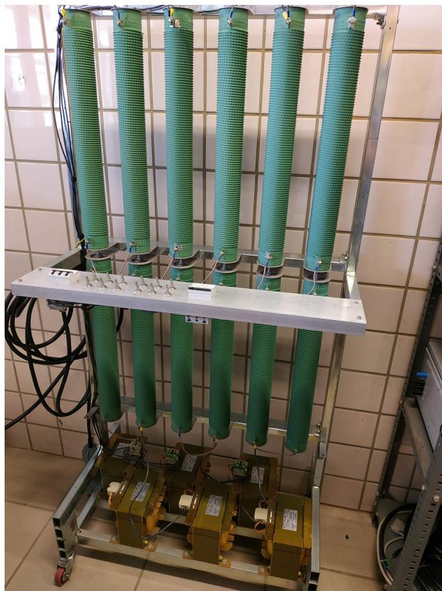
**Figura 6.2** Carga *RL* trifásica del laboratorio.
