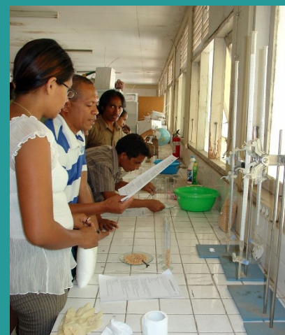
Figura 2 – Atividade laboratorial na aula de Química: determinação da densidade de materiais sólidos
