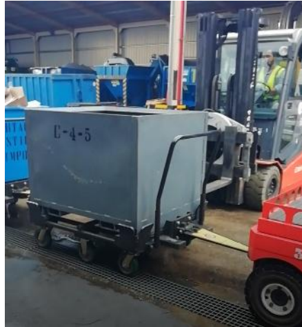
Figura 15- Empilhador utilizado para a carga e descarga de contentor de limalha
