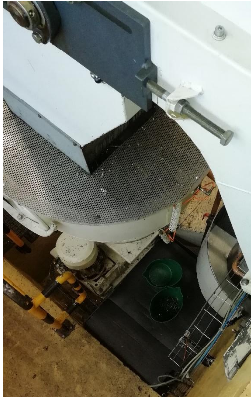
Figura 11- Imagem do triturador com recipientes de limalha cheios para retirar
