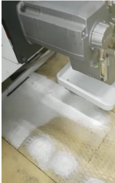
Figura 9- Exemplo da situação da espuma a sobrepor-se à central
