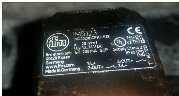
Figura 40- Sensor de proximidade adotado nas dragas secas
