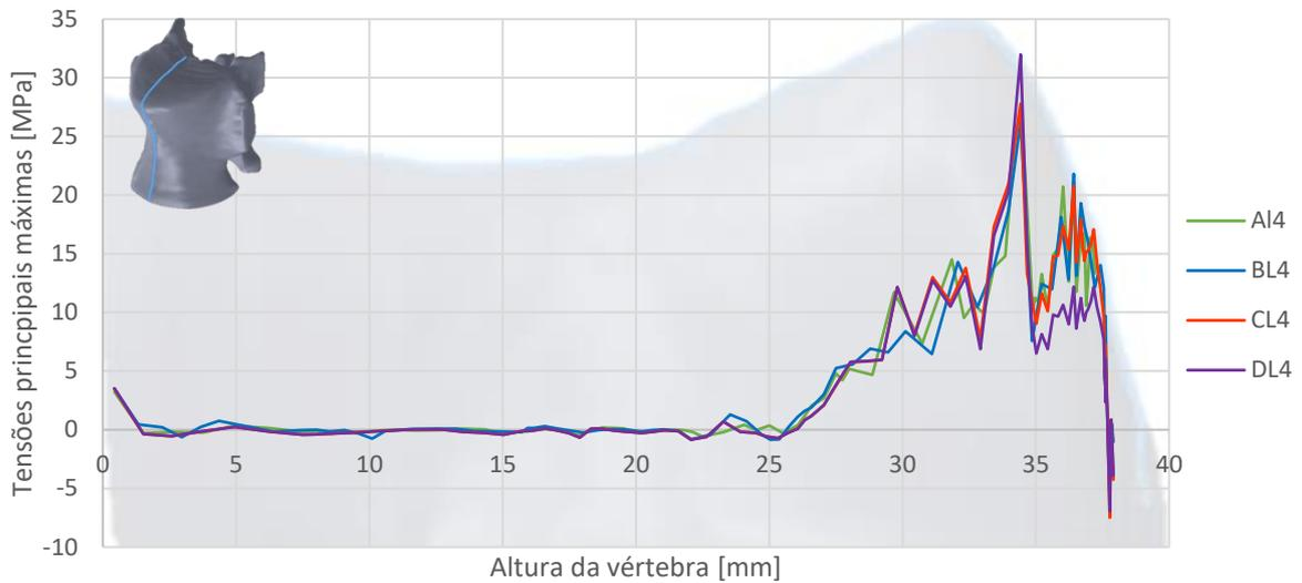
Gráfico das Tensões principais máximas ( $\sigma_1$ ) da vértebra ao longo do corte no plano medial no osso esponjoso para a vértebra intacta (AL4), com defeito (BL4), cimentada com Cerament® (CL4) e cimentada com Vertecem® (DL4).
