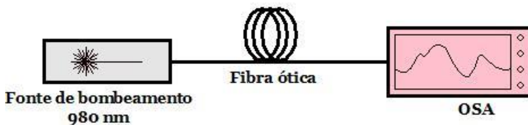
Figura 3.18 – Esquema da montagem experimental utilizada na caracterização das fibras óticas para potências elevadas.
