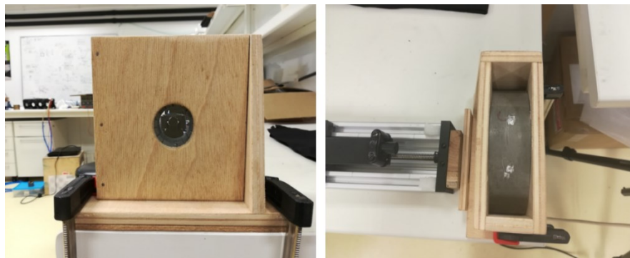
Figura 24. Suporte do Halbach em madeira e grampos utilizados.
