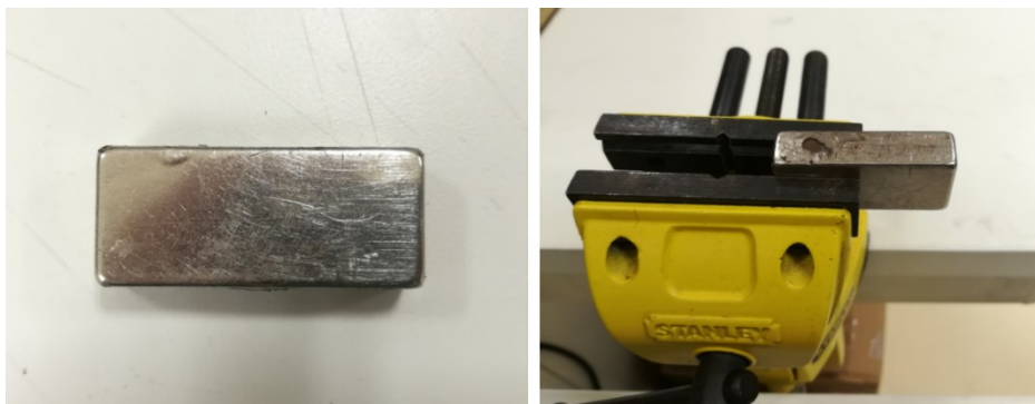
Figura 20. Ímã de Nd-Fe-B (esquerda) e torno utilizado para suportar o ímã (direita).
