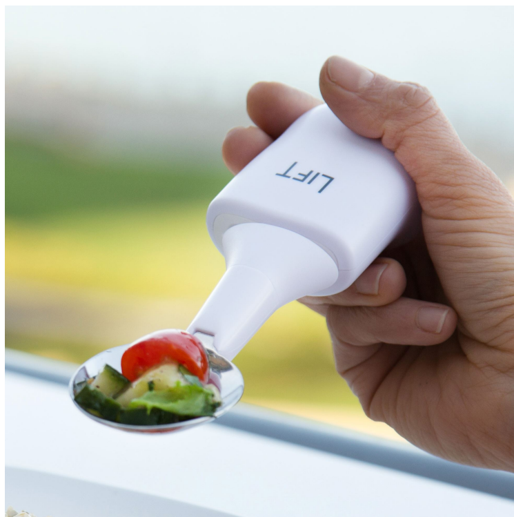
Figura 8. Colher inteligente para redução dos problemas de movimentos e tremores característicos da Doença de Parkinson na alimentação (Liftware, n.d.).
