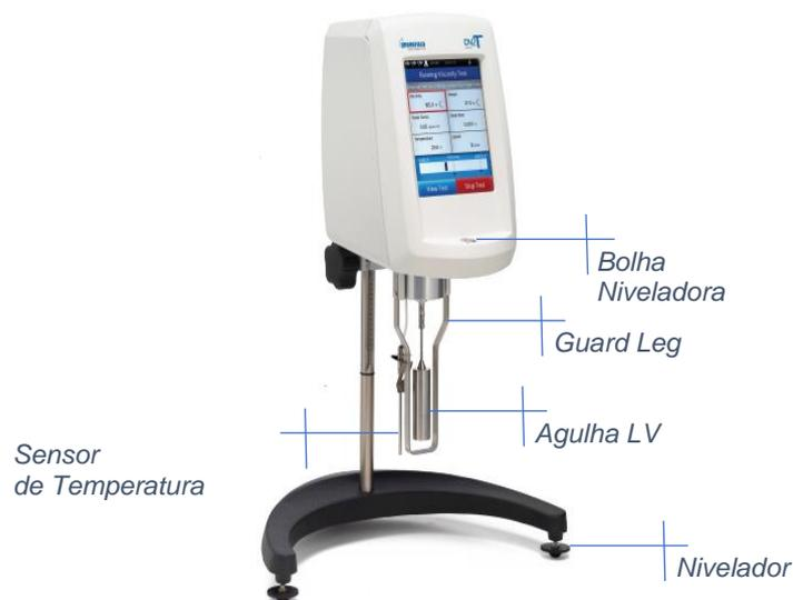
Figura 18 - Viscosímetro Brookfield DV2T, [28].
