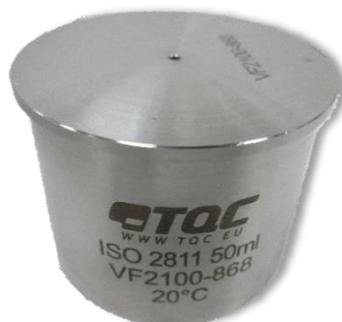
*Figura 17 - Picnómetro de 50 mL de volume.*
