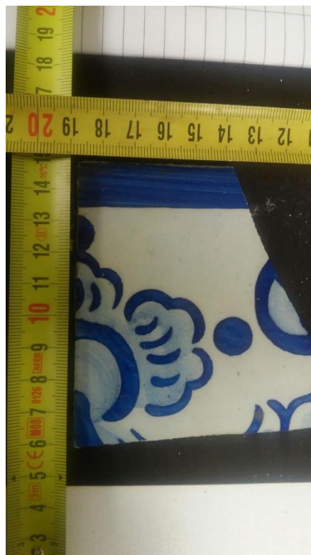
Figura 65 - Amostra de azulejo, antes da regularização
