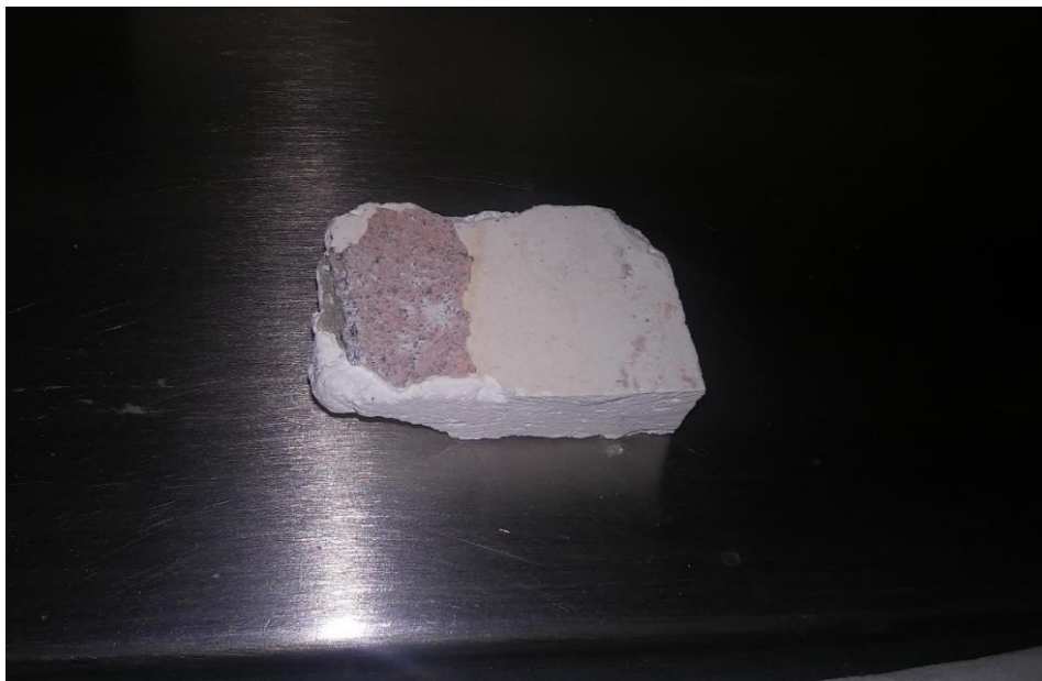
Figura 69 - Formato final de amostra te teto de varanda após a regularização
