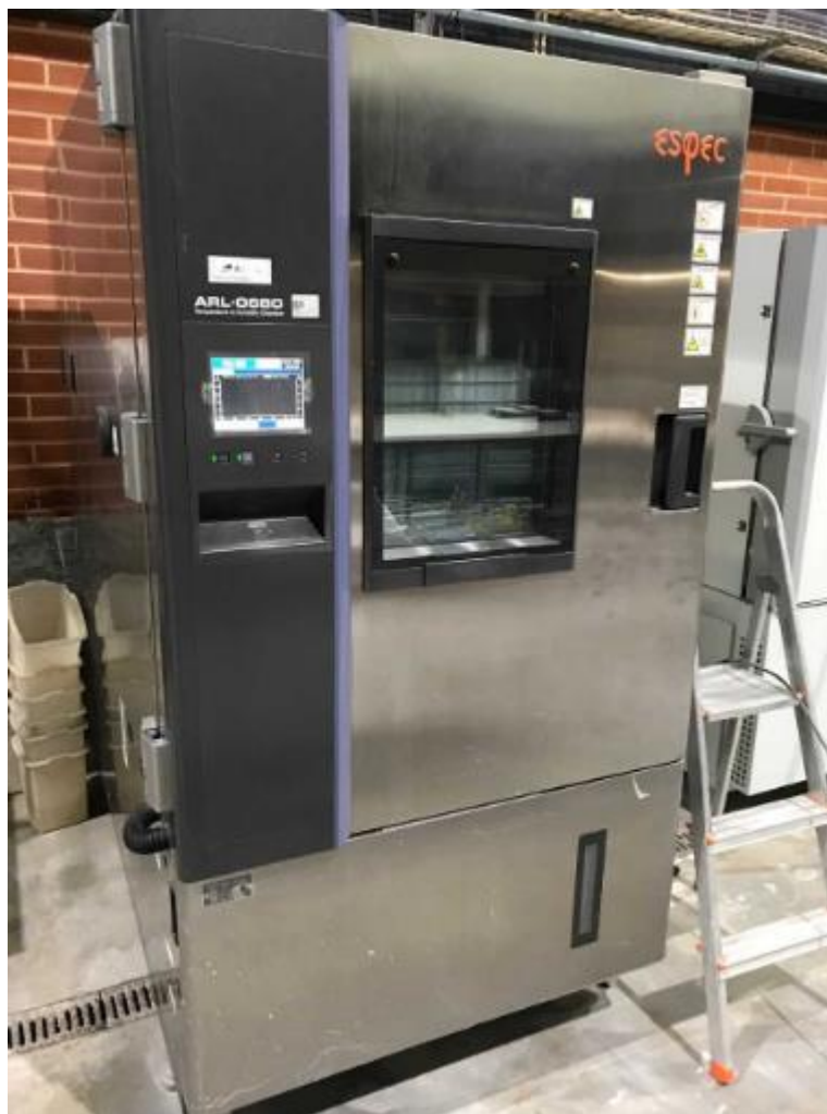
Figura 73 - Equipamento utilizado no ensaio de determinação de vapor de água
