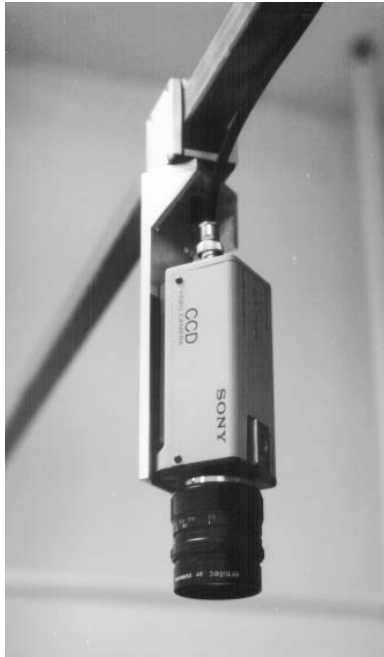
Fig. 13 - A câmara utilizada e o respectivo suporte orientável.
