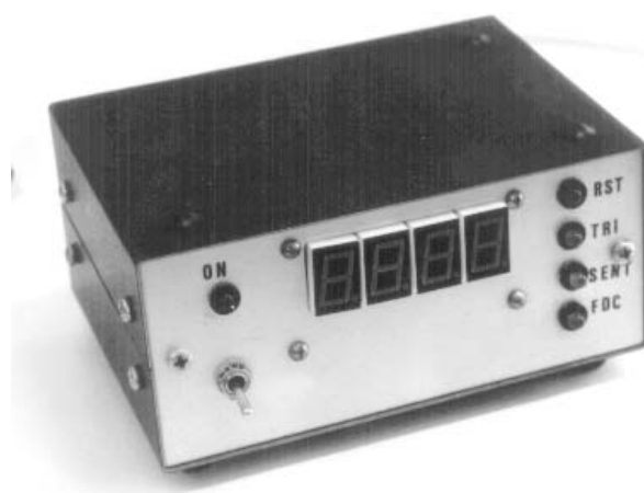
Fig. 22 - A montagem final de todo o circuito de controle.
