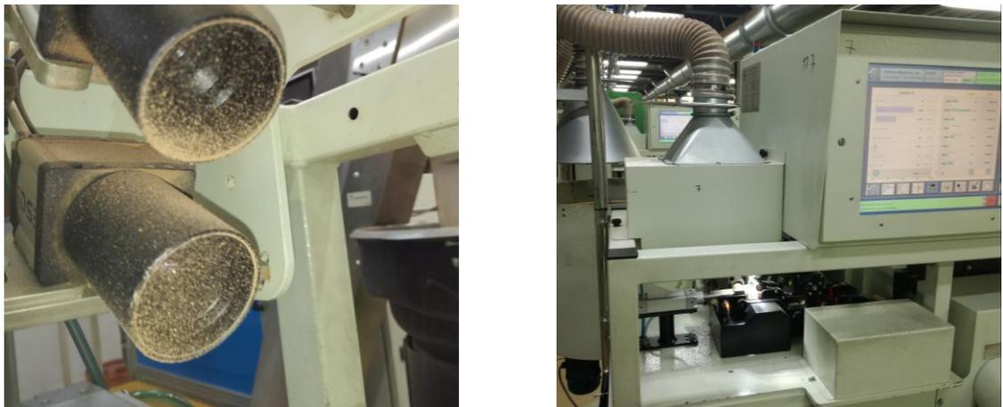
Figura 8 - Estado das lentes das câmaras e sistema de aspiração inicial
