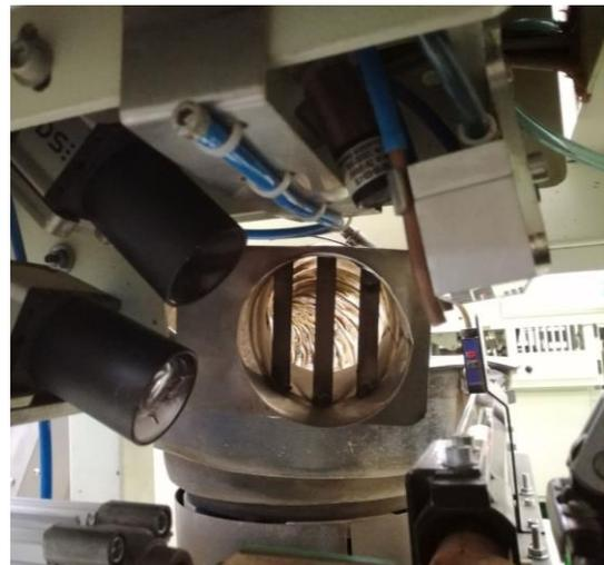
Figura 11 - Sistema de aspiração e limpeza instalado
