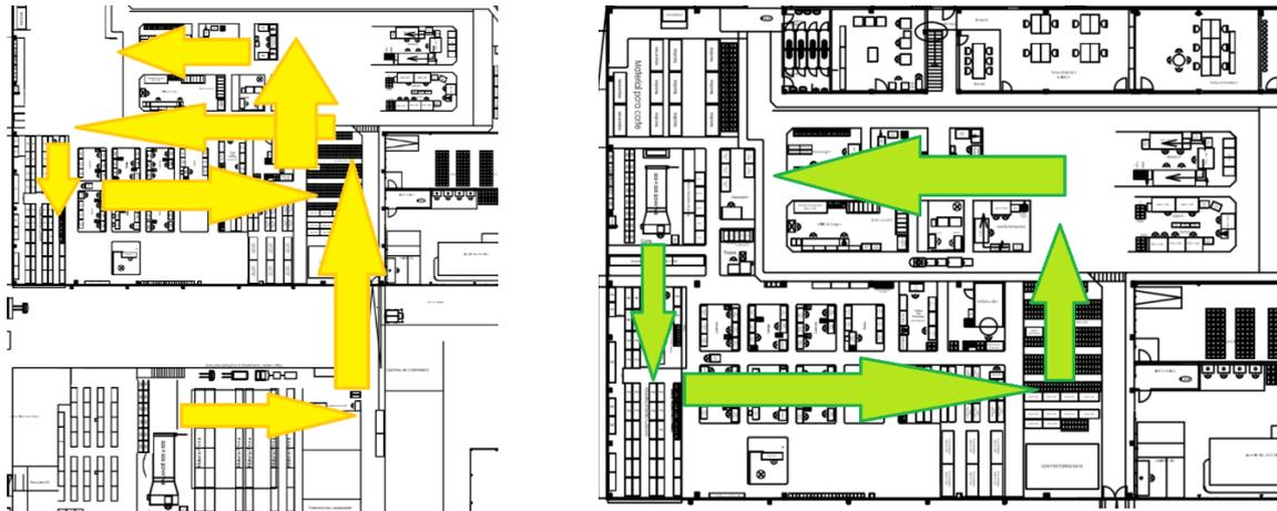
Figura 37. Fluxo Processo Produtivo Atual (Esquerda) e Fluxo Processo Proposto (Direita).
