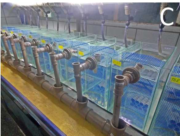
Figura 13 - Sistema de recirculação de água fechado dinâmico experimental para reprodutores de Macrobrachium pantanalense . Visão geral do sistema (A); Vista de aquários individuais (B); Nível experimental de aquários (vista esquerda e direita) (C, D).
