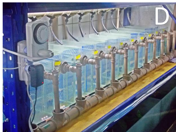
Figura 13 - Sistema de recirculação de água fechado dinâmico experimental para reprodutores de Macrobrachium pantanalense . Visão geral do sistema (A); Vista de aquários individuais (B); Nível experimental de aquários (vista esquerda e direita) (C, D).
