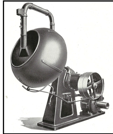
Turbine à séchage par air chaud Ed. Frogerais
