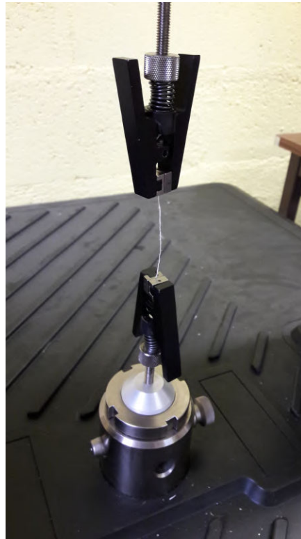
FIGURE 4.6 – Montage des fils dans les mors de la machine
