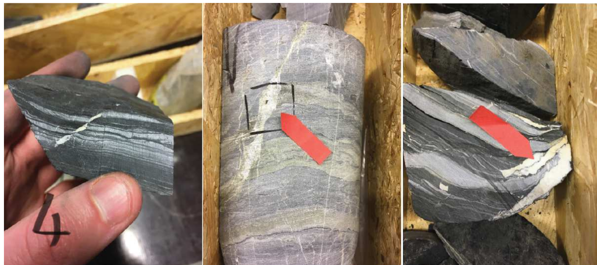
Figure 2: Échantillons de carottes montrant les veines de calcites remplissant les failles et les fractures.
