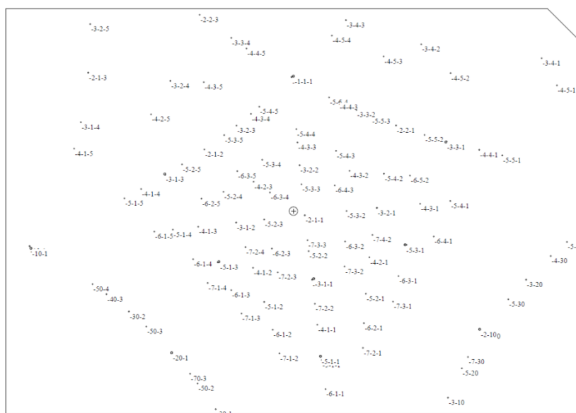
Figure 55 Diffractogramme de Laue théorique de la cuprite cubique indexé après avoir été ajusté aux points expérimentaux mesurés dans le cas de la cuprite présentée par le fournisseur comme orientée (111)
