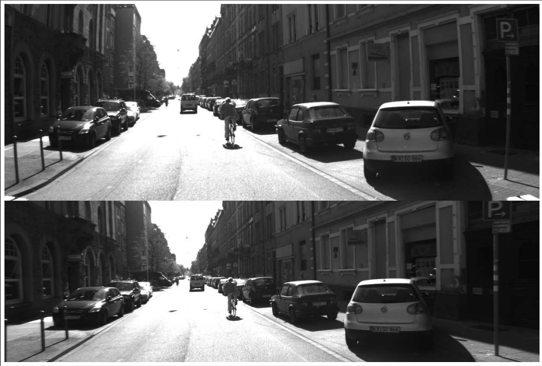
FIGURE 1.5 – Correction des distorsions. En haut, la vue distordue, en bas, la vue corrigée. La distorsion en barillet est visible sur le poteau à droite de la première vue.
