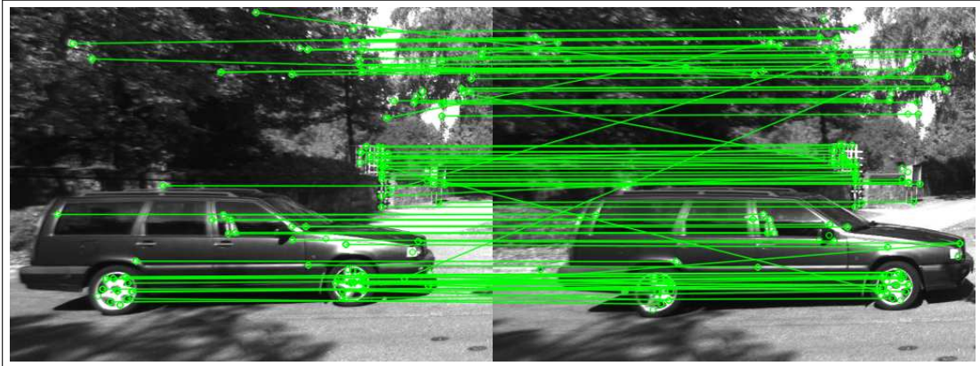
FIGURE 1.7 – Détection, description et appariement de points d'intérêts. On peut remarquer la présence d'appariements erronés entre couples de points d'intérêts ne correspondant pas au même point de la scène.
