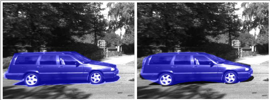
FIGURE 3.3 – Labellisation d’un objet mobile pour la mesure de précision et de rappel. À gauche, une labellisation manuelle et à droite, une labellisation automatique avec MASK R-CNN ne prenant pas en compte l’ombre portée du véhicule.
