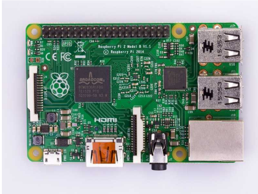
Figura 2.2: Raspberry Pi 2 Model B (immagine tratta dal sito ufficiale).
