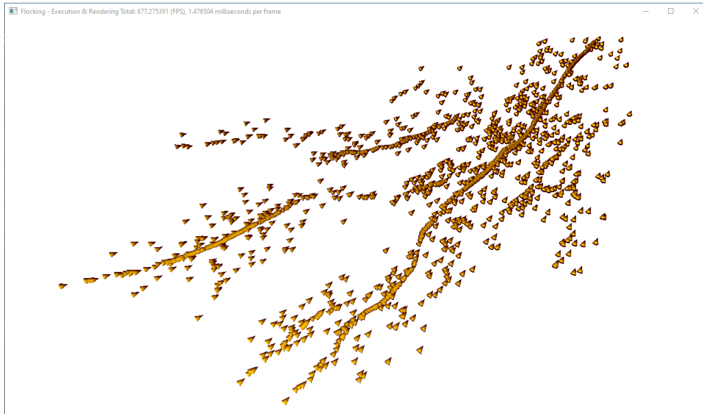
Figura 5.4: La rimozione della regola della separazione produce la formazione di un serpente di agenti. In questa immagine il serpente non è ancora del tutto unito.
