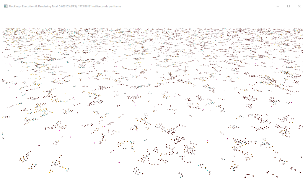
Figura 5.12: Un milione agenti immersi in uno spazio quadrato di lato 50.000, a 5.6 fps con 177 millisecondi per frame. Il raggio visivo e il partizionamento hanno lunghezza 2,0.
