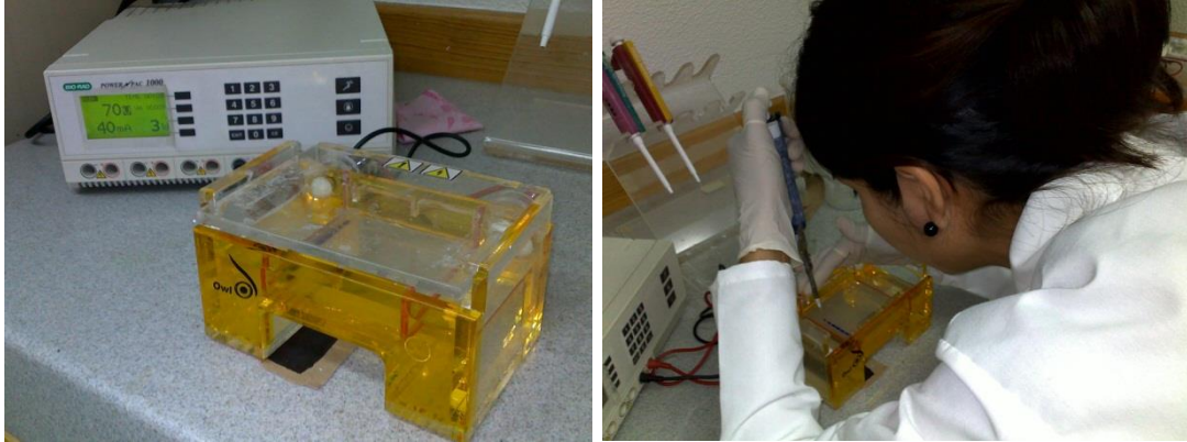
Fig. 17. Cámara electroforética utilizada y colocación de muestras en gel de agarosa
