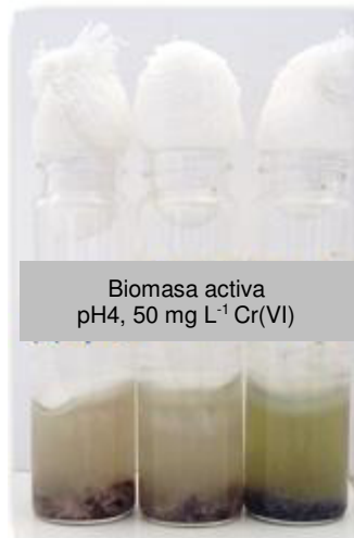
Figura 21. Ensayo de eliminación de Cr(VI) por biomasa activa de Fusarium oxysporum .
