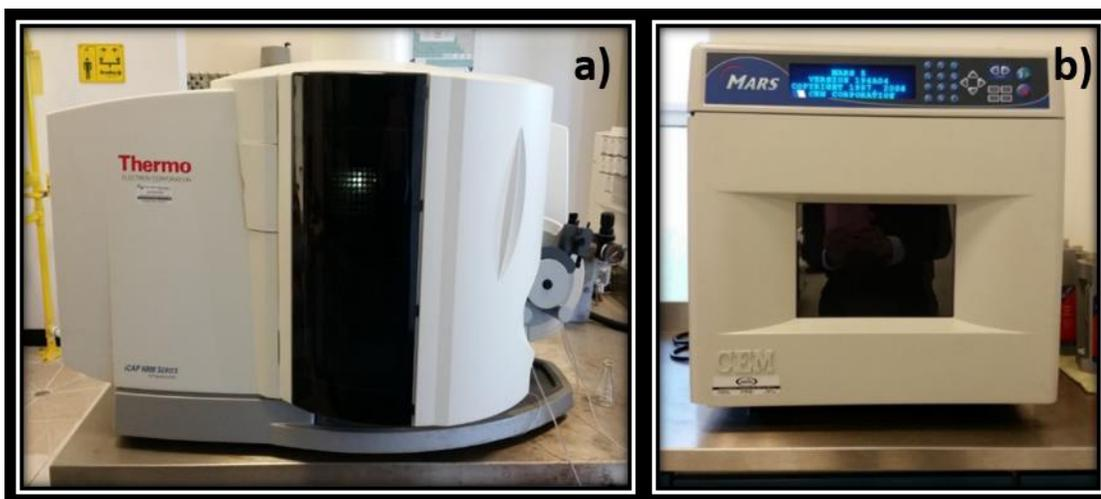
Figura 9. (a) Espectrómetro ICP-AES marca Thermo Electron Corp. y (b) Horno de Microondas marca CEM Modelo MARS.
