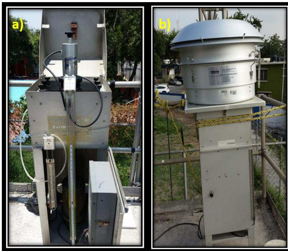
Figura 8. Muestreadores de alto volumen (a) Muestreador PST (b) Muestreador con cabezal para  $PM_{2.5}$
