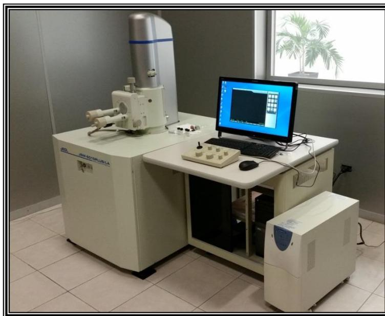
Figura 10. Microscopio electrónico de barrido marca JEOL, modelo JSM-6010 Plus.
