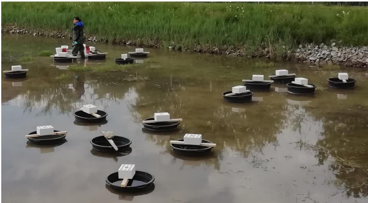
Abb. 15: Anordnung der KRPE aus Versuch 3 in Gruppen (patches) mit je einer Behandlungsvariante im angestauten Teich.
