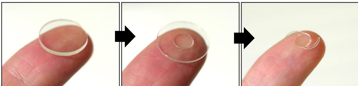
Abbildung 114: Fertigungsprozess eines Polymers von der gestanzten Ronde (links) über einen sog. Saturnring mit optischem Element (mitte) bis zur fertigen IOL (rechts) nach dem Fräsprozess.
