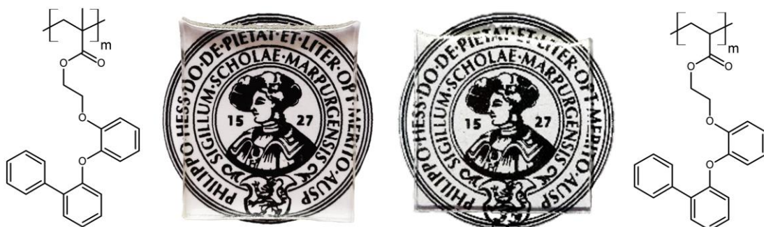
Abbildung 94: Struktureller Aufbau und Erscheinungsbild der dargestellten Homopolymere von Bi2PhEMA (links) und Bi2PhEA (rechts), bei einer mittleren Materialstärke von 2,0 mm.
