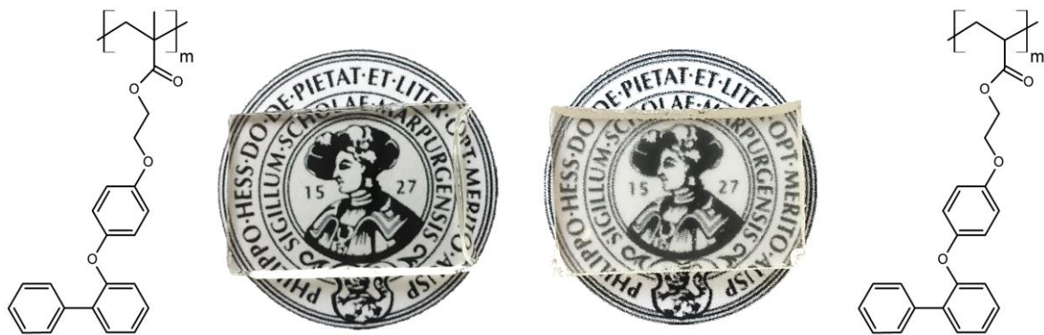
Abbildung 93: Synthetisierte Homopolymere von Bi4PhEMA (links) und Bi4PhEA (rechts), dargestellt über photochemische radikalische Polymerisation. Die mittlere Materialstärke beträgt je 2,0 mm.
