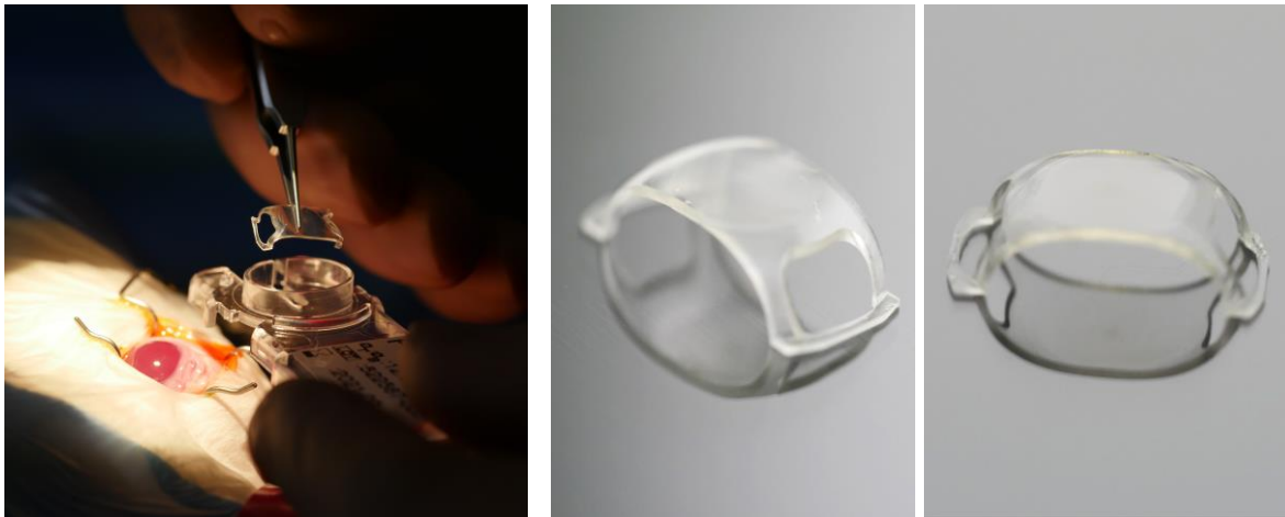
Abbildung 110: Links: Versuch zur Biokompatibilität einer phaken IOL aus einem im Rahmen dieser Arbeit entwickelten HRI-Polymer; Rechts: Makroaufnahme der pIOL aus zwei unterschiedlichen Betrachtungswinkeln.
