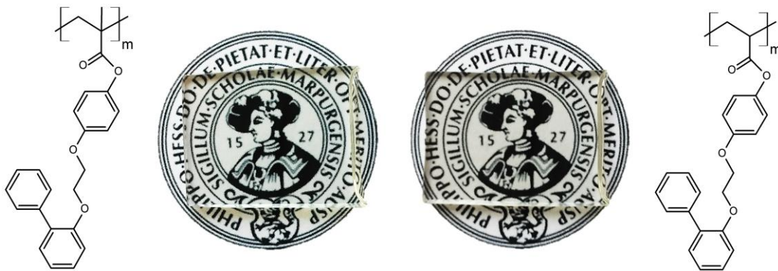
Abbildung 96: Homopolymere von BiE4PhMA (links) und BiE4PhA (rechts), nach photochemischer radikalischer Polymerisation. Die mittlere Stärke der Polymerplatten beträgt jeweils 2,0 mm.
