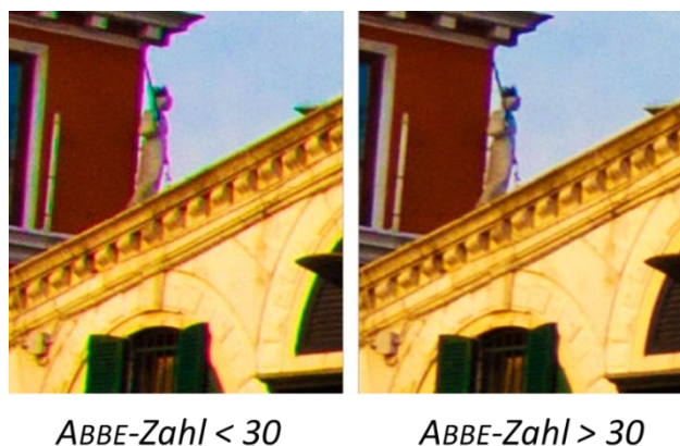
Abbildung 6: Visuelle Darstellung der chromatischen Aberration bei Betrachtung durch eine Optik mit niedriger ABBE-Zahl (links) und entsprechende Referenz mit hoher ABBE-Zahl (rechts). [73]
