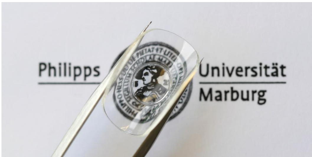
Abbildung 116: Saturnring eines neuartigen Copolymers auf Triaryl-Basis mit hoher optischer Transparenz. Das hochbrechende Material ( n_D = 1,583 ) zeichnet sich durch eine hohe Flexibilität ( T_g = 22 °C), eine gute Abbildungsleistung ( v_A = 31,5 ) und hohe UV-Beständigkeit (BW: 6) aus.
