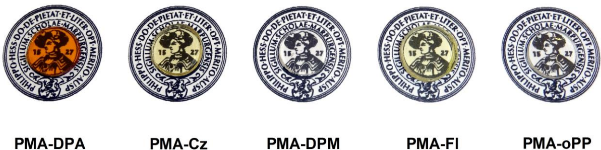
Abbildung 48: Übersicht synthetisierter Polymerronden aus hochbrechenden Polymethacrylaten, jeweils mit einer Probendicke von d = 1 \text{ mm} und einem Durchmesser von \varnothing = 8 \text{ mm} .
