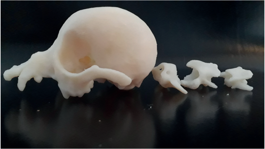
Abbildung 24: 3D-Druck des Schädels, Atlas, Axis und dritten Halswirbels von Hund 1.
