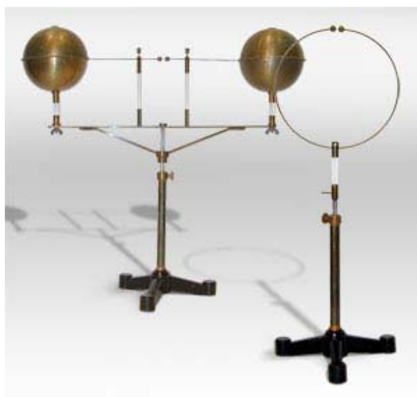
Экспериментальная установка Г. Герца (1887)
