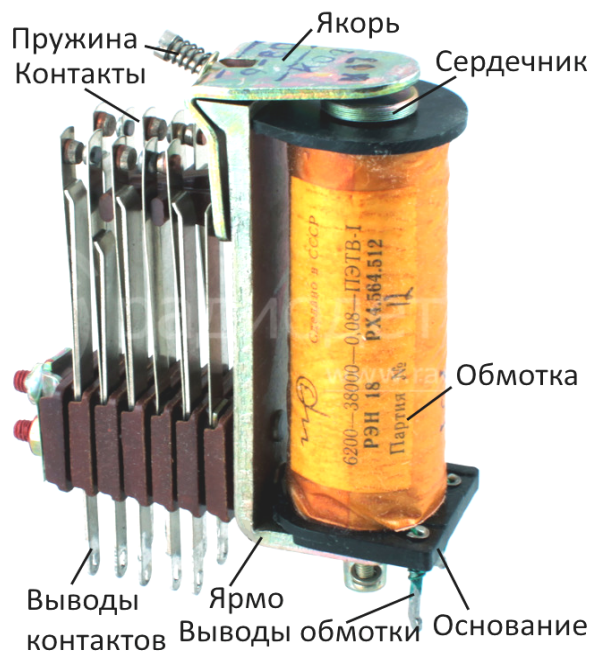
Устройство реле
