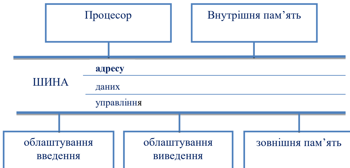
Рис. 2.2. Функціональна схема комп'ютера
