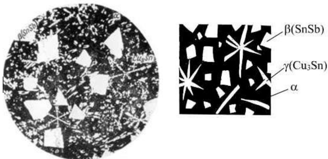
Рисунок 1.3.1.1 – Микроструктура баббита Б83 (11% Sb, 6% Cu, остальное Sn). x100. Структура состоит из \alpha -твердого раствора (темная основа), крупных кубических кристаллов (SnSb) (светлые) и химические соединения Cu_3Sn (в форме звездочек). Справа – схематическое изображение микроструктуры
