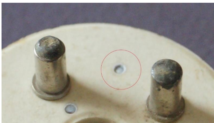
Рисунок 2.2.1 Подложка после 10 проходов лазерным лучом
