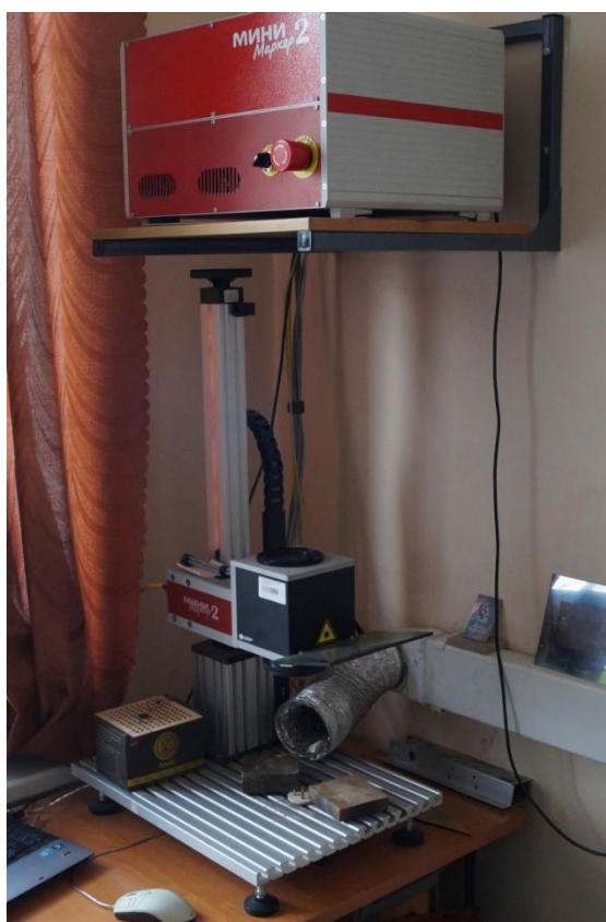
Рисунок 2.1.1 – Фото экспериментальной установки с подложкой из Al_2O_3
