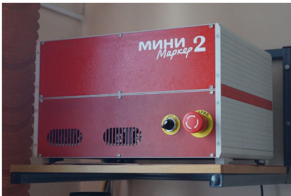
Рисунок 2.1.1.1 – Волоконный иттербиевый импульсный лазер IPG-Photonics «Мини маркер 2»
