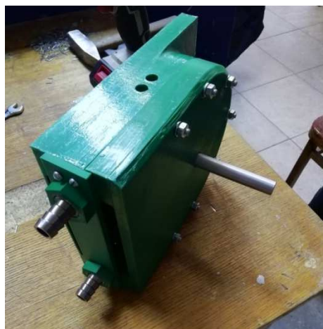
Рис. 2 - Изготовленный прототип перистальтического насоса методами аддитивного производства
