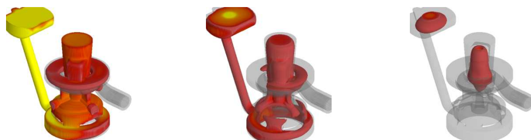
Рис. 4. Процесс кристаллизации отливки
