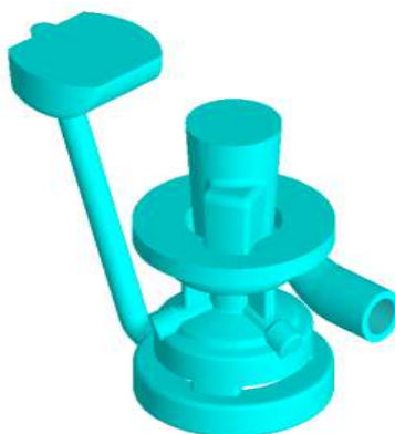
Рис. 2. 3D-модель отливки «Корпус насоса»
