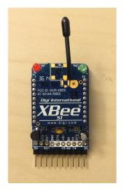
Fig. 3.2. XBee Series 1 module
