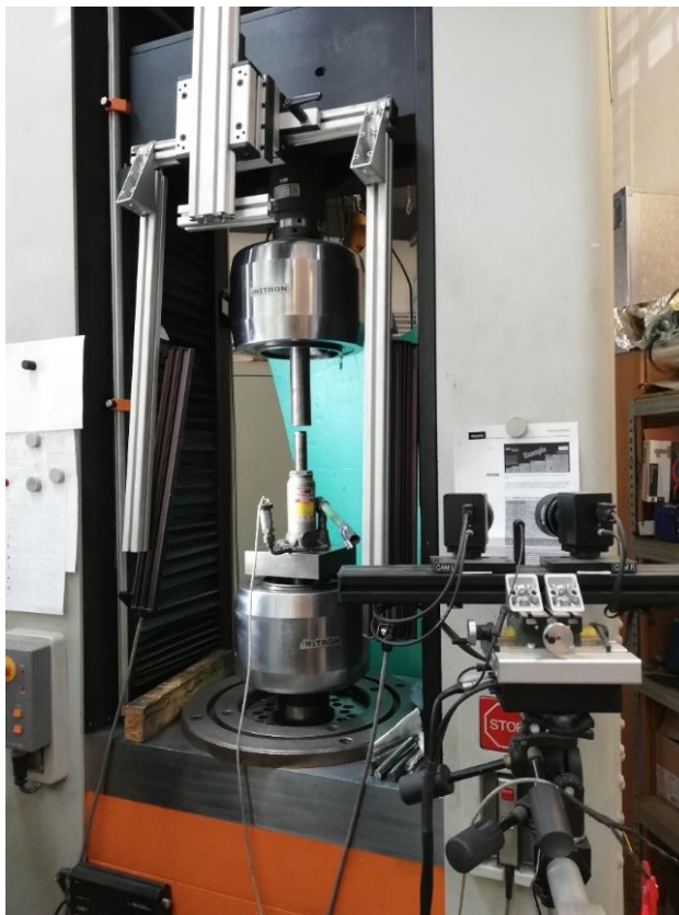
Slika 6.2: Umerjanje hidravlične dvigalke
