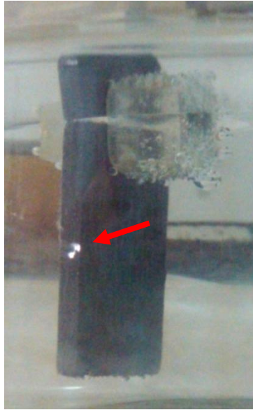
Figura 3.18: Arcos eléctricos en la superficie de ánodo de TiG2.
