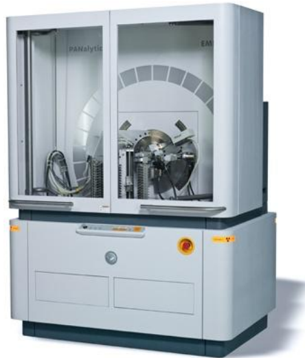
Figura 3.12: Difractómetro de Rayos X. Panalytical, Empeyan.
