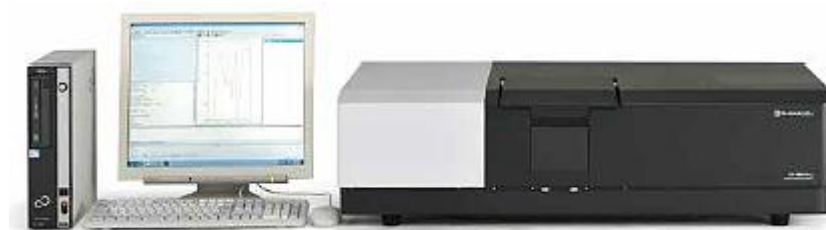
Figura 3.13: Espectrofotómetro UV-Vis-IR. Shimadzu UV-3600.
