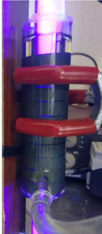
Figura 6.9: Fotografía del fotorreactor. Detalle de la ubicación de los anillos. Ensayos de transformación de Cr(VI) en presencia de anillos recubiertos con TiO 2 .
