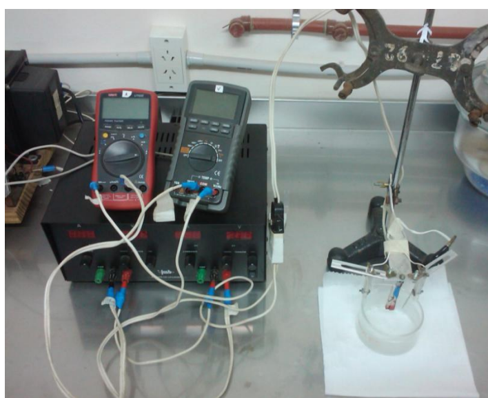
Figura 3.6: Equipamiento de anodización y celda electroquímica
