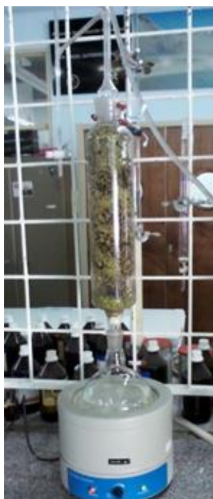
Figura 3. Destilador de arrastre con vapor de agua con trampa tipo Clevenger.
