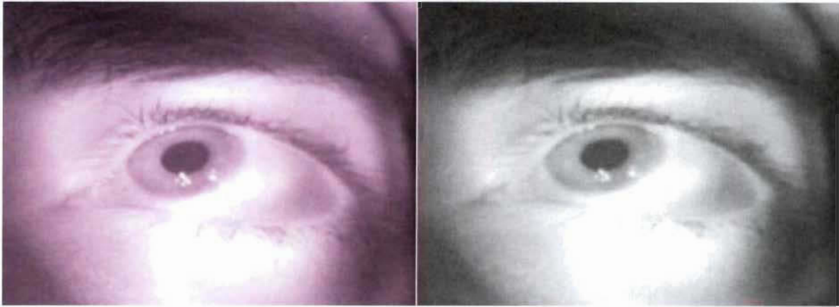
Figure 18 : Conversion de l'image original en niveau de gris. (a) Image originale RGB. (b) Image convertie en niveau de gris.
