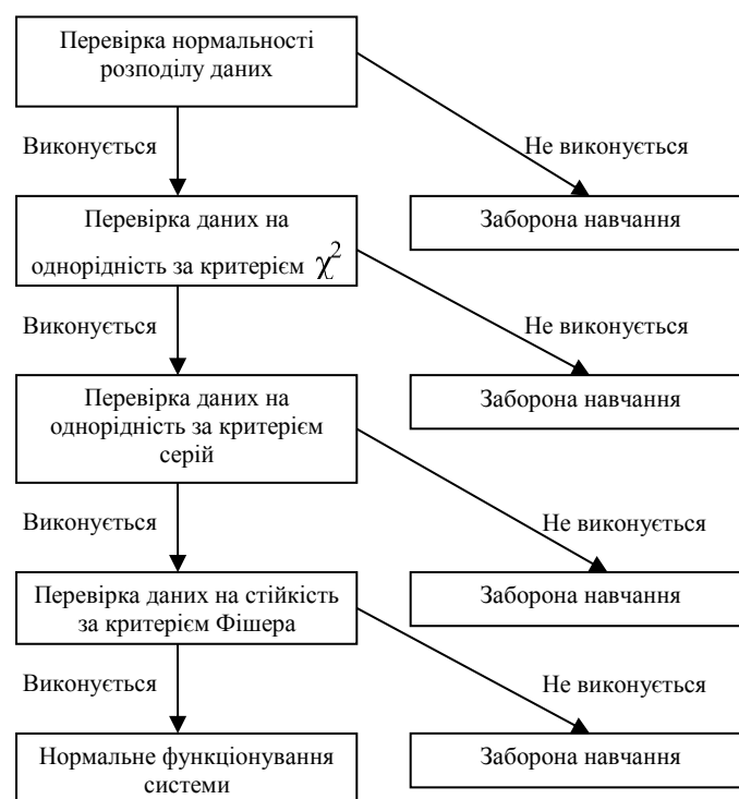
Рисунок 1.6 – Ієрархічна структура алгоритму оцінки статистичних стійкості та однорідності навчальної вибірки
