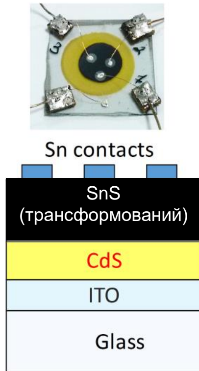
Рисунок 7.1 - Зображення виготовлених лабораторних зразків фотодетекторів на основі трансформованої плівки SnS та ескіз пристрою, що досліджувався.
