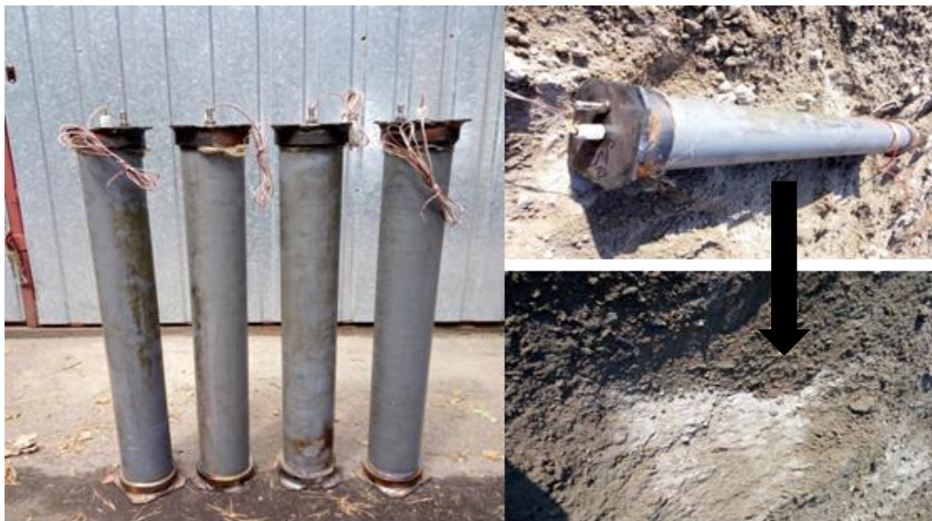
Rys. 4. Po lewej stronie widok przygotowanych ładunków, po prawej efekt odpalenia
