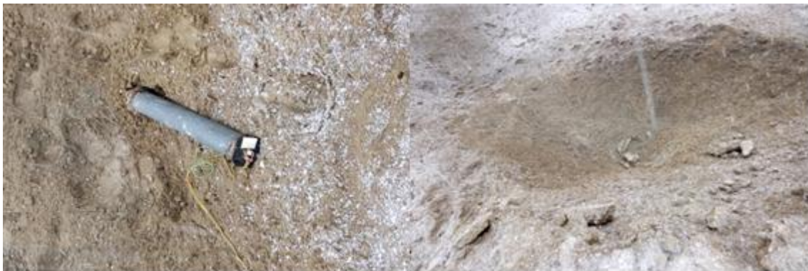
Rys. 7. Rura testowa zdetonowana po 30 dniach składowania pod ciśnieniem 10 bar
