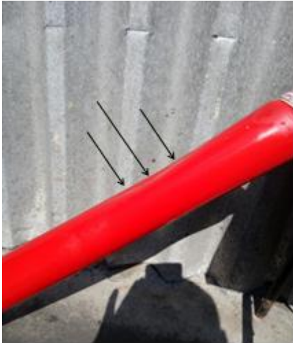
Rys. 5. Widoczna deformacja ładunku wyjętego z rury testowej
