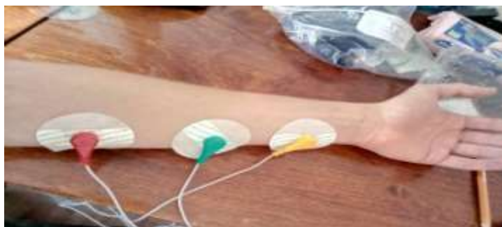
Рисунок 3.1 – Розташування електродів міографічного датчика на руці
