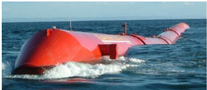
Abbildung 15: erstes kommerzielles Wellenkraftwerk mit Pelamis –Anlagen vor der portugiesischen Küste bei Agucadoura (ResearchGate, 2011)
