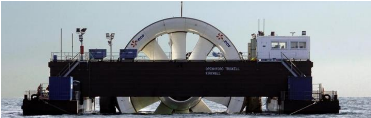
Abbildung 5: erstes Gezeitenkraftwerk im offenen Meer vor der Küste Frankreichs in der OpenHydro -Bauweise (Wetzels, 2012)
