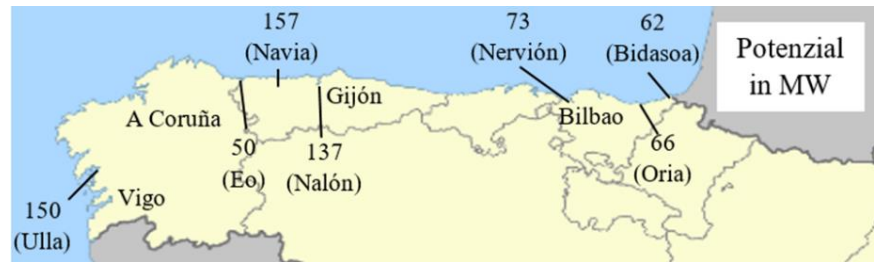
Abbildung 46: osmotisches Potenzial der Flüsse mit einem durchschnittlichen Abfluss von über 20 \text{ m}^3/\text{s} an der nördlichen Atlantikküste bezogen auf den jeweiligen Gesamtabfluss
