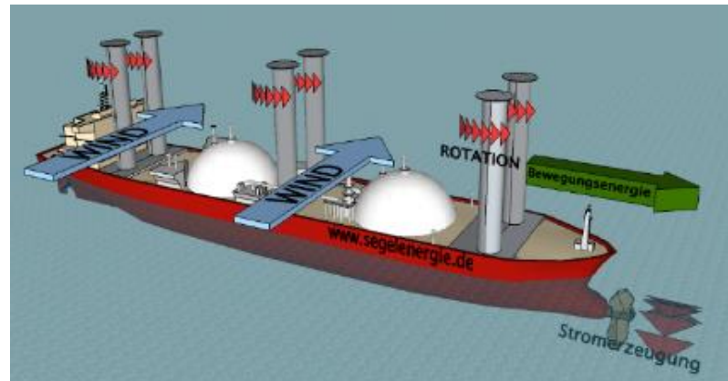
Abbildung 22: Aufbau- und Funktions-skizze eines Energieschiffes mit Flettner-Rotoren (Sterner M. , 2013, S. 23)
