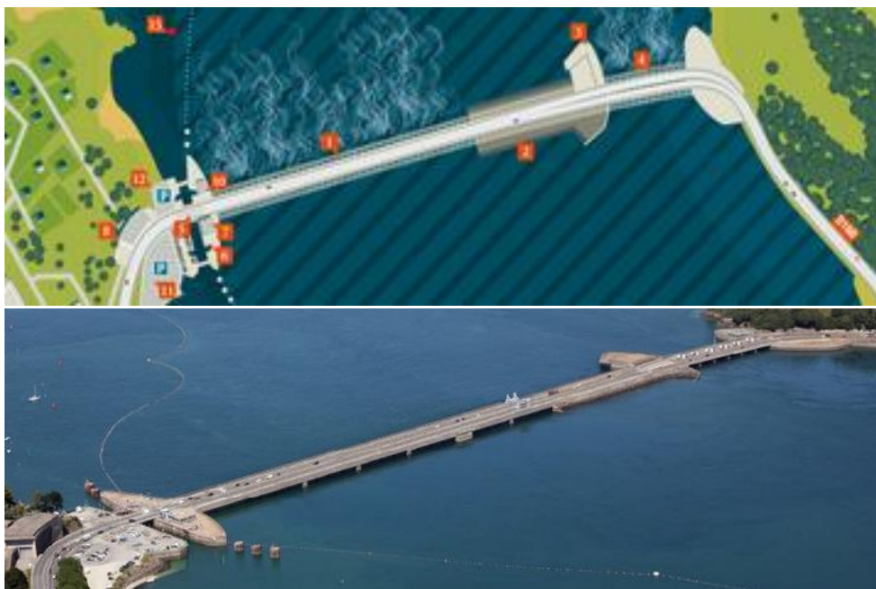
Abbildung 7: Ausschnitt aus dem offiziellen Lageplan der „Usine marémotrice de la Rance“ der EDF (oben) und Luftaufnahme des Sperrwerkes mit integriertem Schleusenbau- und Gezeitenkraftwerk (unten) (EDF, 2008) (Rath, 2018)
