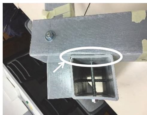
(d) Slip at element interface
