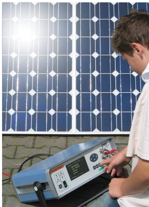
Figura 2.1-34. Medidor de rendimiento máximo
