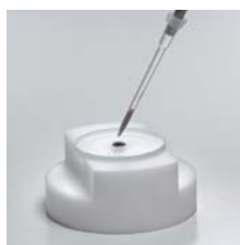
Figura 41: Deposición de la dilución del suelo en un portamuestras.
