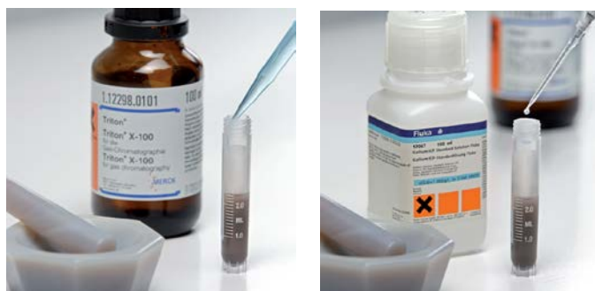
Figura 40: Añadidura de Tritón X 100 e estándar interno de Galio para posterior homogeneización.
