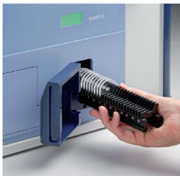
Figura 43: Casete de porta-muestras siendo introducido en el equipo para la toma de espectros.
