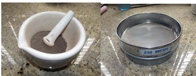
Figura 38: Mortero usado para pulverizar la suelo y tamiz usado para seleccionar granos de 53 micrones.
