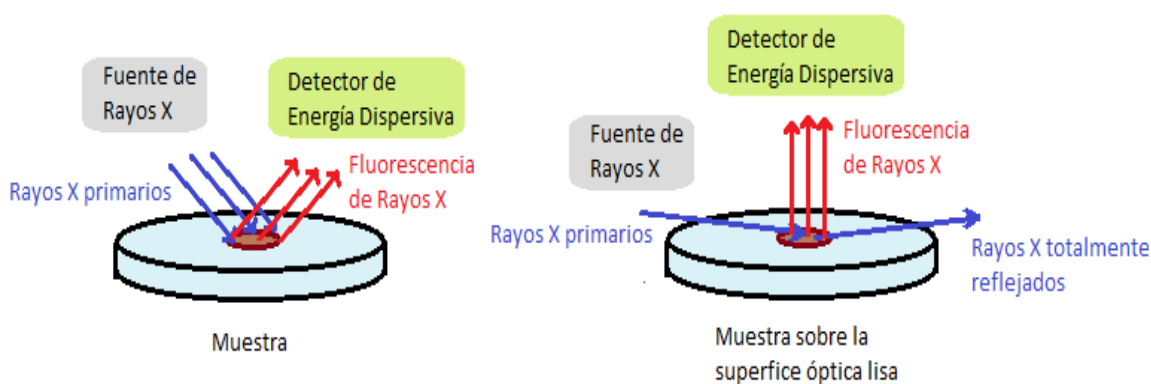
Figura 17: Fluorescencia de rayos X por Dispersión de Energía (izquierda) y por Reflexión Total (derecha).
