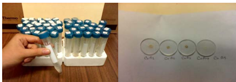
Figura 42. Diluciones de muestras realizadas contenidas en tubos de plástico de laboratorio y analitos de estudio listos para ser medidos.
