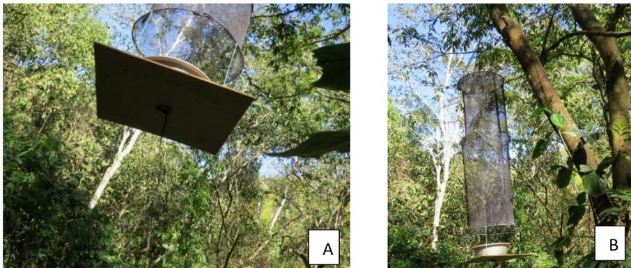
Figura 12. A. Soporte colocado en bases de trampas Van Someren-Rydon para evitar pérdida de datos por caída o movimiento de la misma, B. Trampa Van Someren-Rydon instalada y activada.
