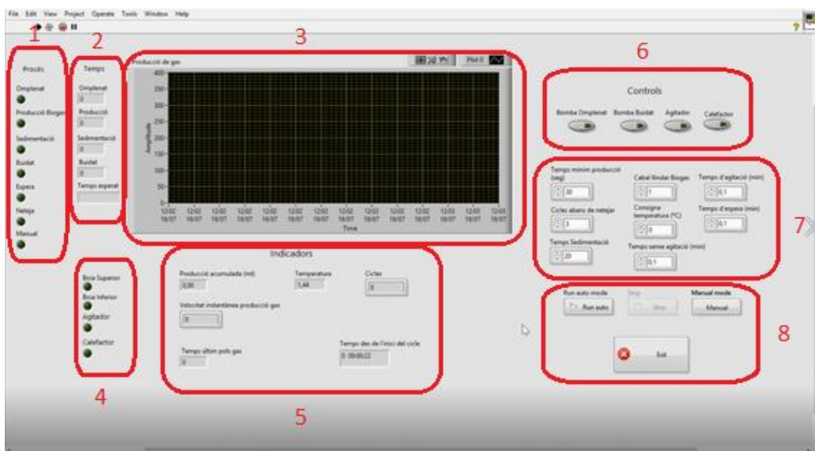
Imatge 3: Interfície d'usuari del software per al bioreactor
