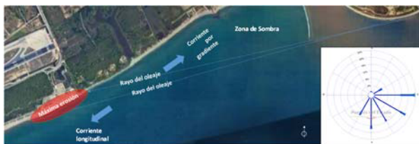
FIGURA 4. Formación de una divergencia en el transporte longitudinal debido a la difracción.
