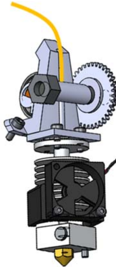
Figura 175. Un dels capçals que formaria part del conjunt revòlver. Quan es posiciona per treballar, l'engrenatge que es mostra ha d'acoblar-se al pinyó motriu del mecanisme extrusor. Font: [322].
