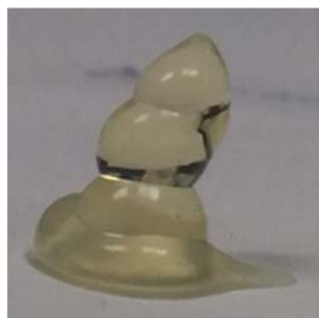
Figura 207. Apilat fet manualment mitjançant xeringa de quatre gotes de silicona curable per llum UV. Font: [328].
