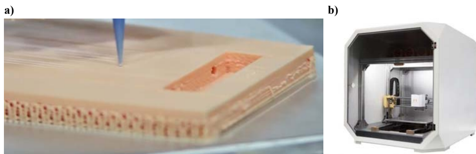
Figura 114. a) Impressió 3D d'una peça per injecció de silicona. b) Impressora 3D amb capçal preparat per incorporar sistema de dispensació de silicona. Font: [267].
