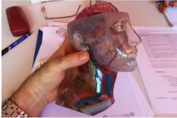
Figura 110. Prototip per a formació mèdica fet per Avinent®, membre de la Comunitat RIS3CAT “Lavor 3D” i soci del projecte QuirofAM, amb una impressora 3D J750™ de Stratasys®. Font: pròpia.
