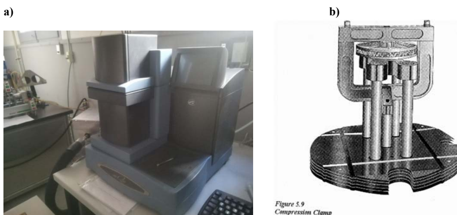
Figura 34. a) Aparell Q800 de TA Instruments per assaigs DMA a l'IQS. Font: pròpia. b) Mordassa de compressió de l'aparell.
