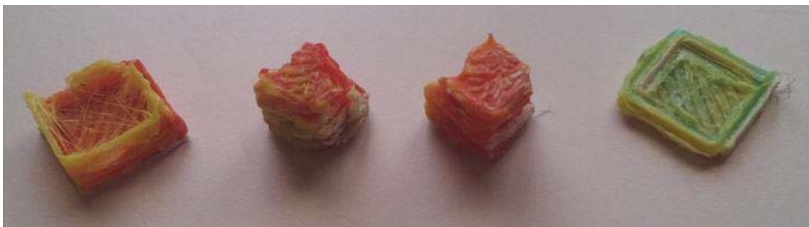
Figura 226. Proves realitzades amb la impressora de 4 broquets independents convergents en un punt. Font: [315].
