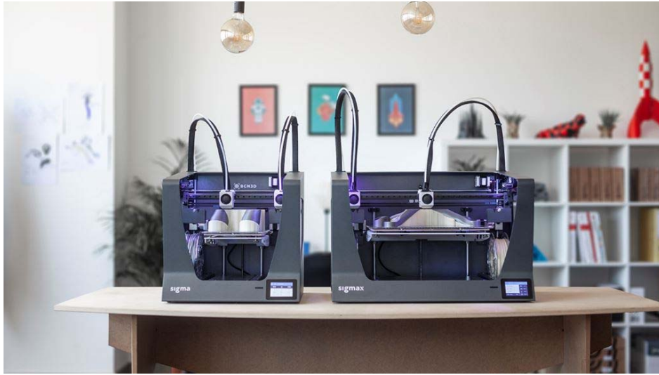
Figura 95. Impressores 3D BCN3D Sigma i Sigmax (CIM UPC) amb tubs Bowden . Font: pròpia.
