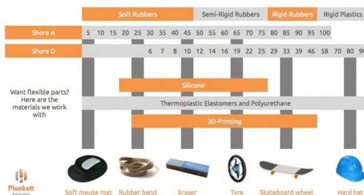
Figura 48. a) Posicionat de materials industrials i exemples de productes en les escales Shore A i D de dureses. b) Duròmetre Shore A i mostra-patró de dureses diferents. Font: [138].
