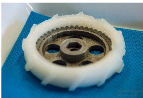
Figura 124. Peça multimaterial constituïda per dues peces impreses en 3D, una de silicona i l'altra de filament plàstic. Font: [273].
