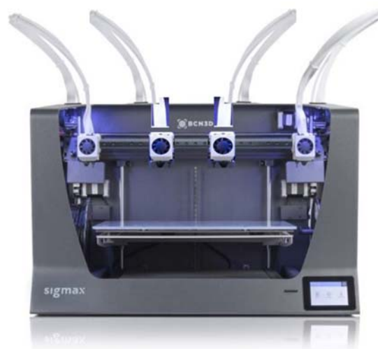
Figura 289. Fotomuntatge d'una impressora BCN3D Sigmoid amb 4 capçals a la guia de moviment de l'eix X. Font: pròpia.
