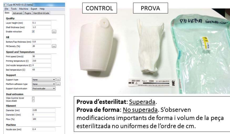
Figura 51. Validació del procés d'esterilització mitjançant autoclau per a peces impreses en 3D. Font: Arnau Valls, HSJD (2017).
