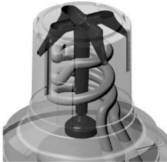
Figura 1. Imatge CAD transparent mostrant els canals interns de refrigeració d'un motlle d'injecció. Font: [4].
