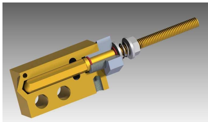
Figura 87. Eix i cambra de barreja activa en una impressora quin capçal rep dos filaments. Font: [198].
