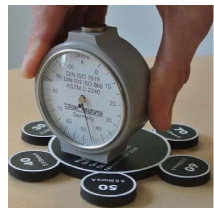
Figura 48. a) Posicionat de materials industrials i exemples de productes en les escales Shore A i D de dureses. b) Duròmetre Shore A i mostra-patró de dureses diferents. Font: [138].
