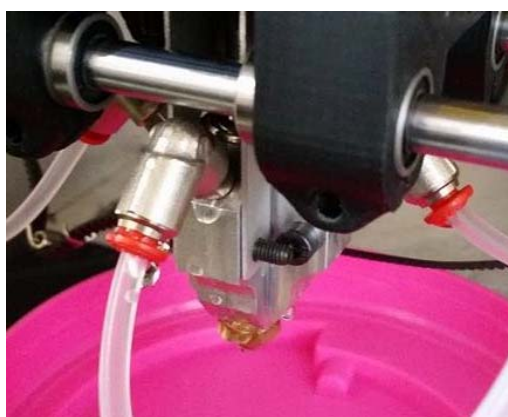
Figura 269. Primeres proves de validació de l'equipament. Verificació de fuites mitjançant circulació d'aigua. Font: [327].
