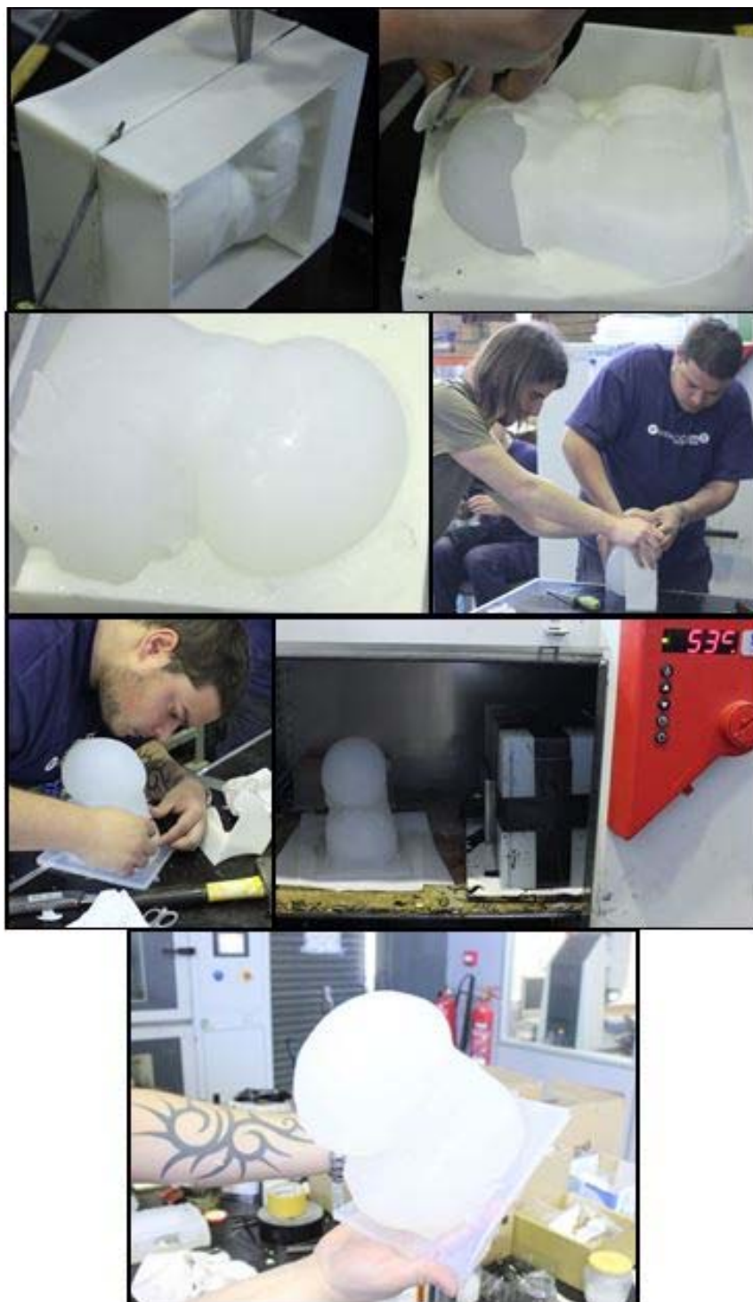
Figura 112. Procés de fabricació del prototip per colada de silicona al motlle, realitzat a la Planta Pilot del CIM UPC. Font: [31].
