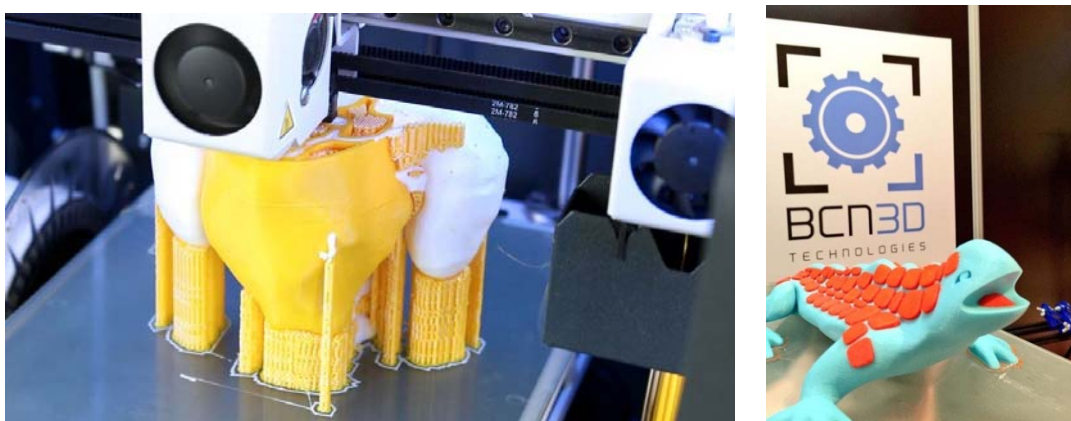
Figura 71. a) Impressora BCN3D Sigma materialitzant un prototip per a cas d'assaig quirúrgic per l'HSJD. b) Peça bicolor ("Draudi") Font: pròpia.
