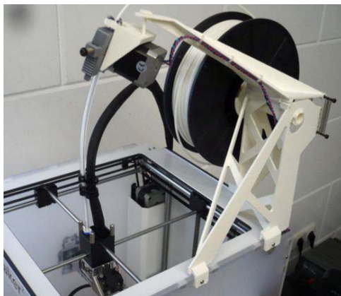
Figura 96. Kit portabobina instal·lat damunt de la impressora 3D per facilitar la impressió 3D de material flexible amb tub Bowden . Font: [211].
