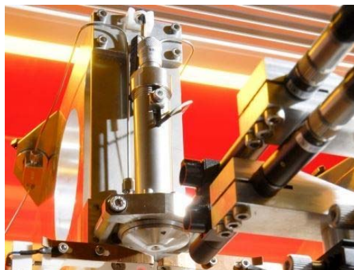
Figura 133. Capçal d'impressió 3D per a líquids basat en una vàlvula piezoelèctric. Font: [286].
