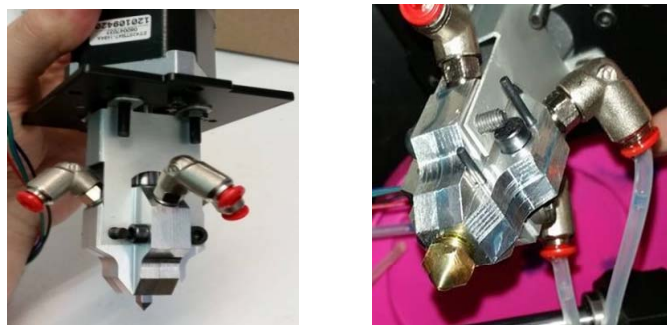
Figura 266. Dues vistes del capçal d'impressió 3D per a poliuretà, amb barreja activa dels líquids, desenvolupat per a la present línia de recerca. Font: [327].
