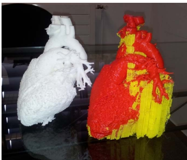
Figura 292. A l'esquerra, cor humà en tecnologia SLS. A la dreta, en FFF- IDEX. Font: pròpia.
