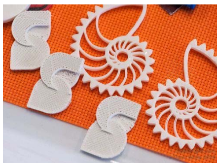
Figura 106. Peces impreses en 3D en làtex. Font: [249].
