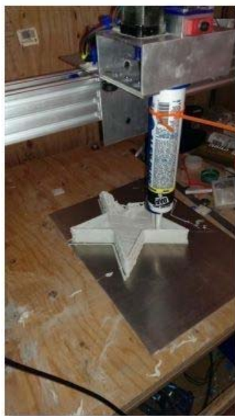
Figura 107. Impressora 3D “Kiloprint” usant un material segellador de làtex. Font: [251].
