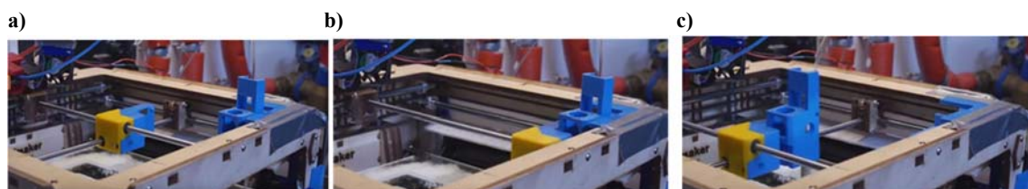
Figura 295. Canvi d'eina en una impressora 3D de codi obert de tecnologia FFF. a) Capçal sense broquet. b) L'eina encaixa en el capçal. c) Posició de treball. Font: [347].
