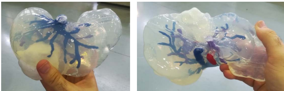
Figura 160. Motlle per a obtenir prototip de fetge en silicona transparent. Font: pròpia.
