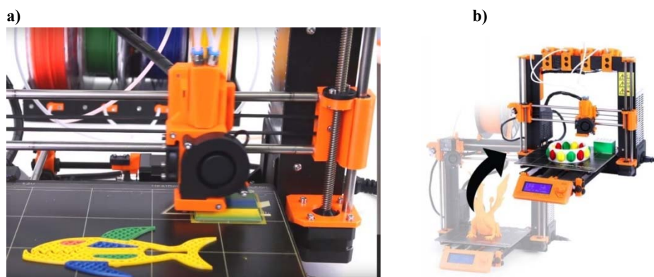
Figura 79. a) Impressora Prusa i3MK2® amb 4 filaments, només un actiu a la vegada. b) Vista general amb el kit multimaterial. Font: [191].
