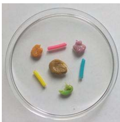
Figura 236. Resultats de l'experimentació prèvia sobre una aproximació al model CMY per a filaments per impressió 3D. Font: [319].
