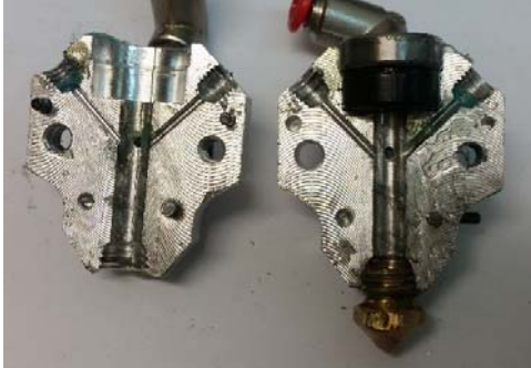
Figura 271. a) Capçal obert després d'una tanda de proves. b) La impressora 3D utilitzada per fer les proves amb poliuretà. Font: [327].
