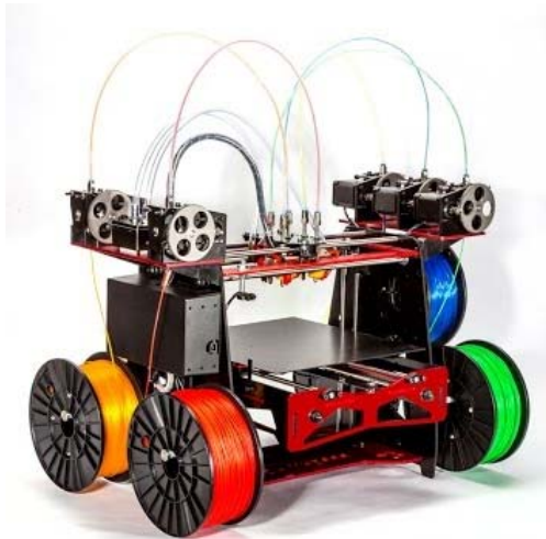
Figura 68. Impressora 3D amb un capçal de 5 extrusors, que marca el límit actual de la tendència d'incorporar múltiples extrusors en un sol capçal. Font: [180].
