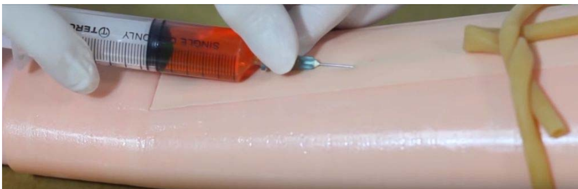
Figura 115. Reproducció de braç humà, fet en silicona mitjançant fabricació additiva. Font: [268].
