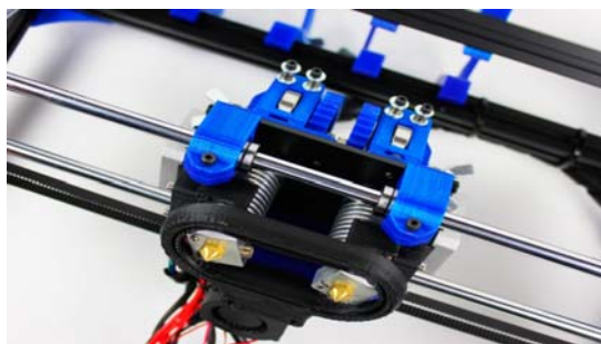
Figura 59. Kit “dual extruder” per a la impressora de codi obert BCN3D+ del CIM UPC. Font: pròpia
