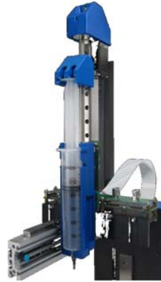
Figura 122. Capçal de Hyrel3D® per a ser usat amb fluids com ara silicones. Font: [272].
