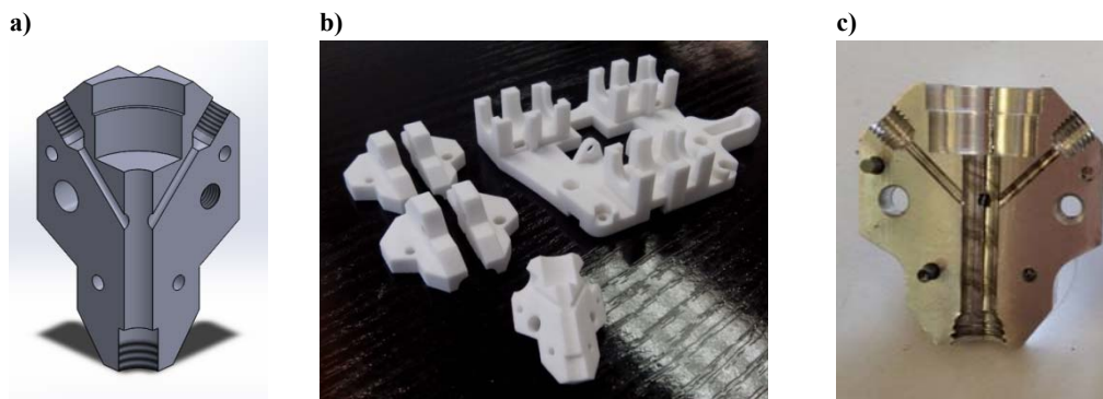
Figura 262. a) Vista CAD d'un quadrant del capçal. b) Prototips de validació de concepte impresos en 3D en tecnologia SLS. c) Dos quadrants premuntats del capçal. Font: [327].
