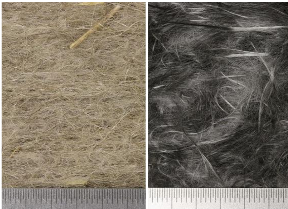
Figura 38. Estructura superficial típica de fibra de lino y de carbono obtenida en el laboratorio DLR mediante una máquina de cardado en seco. Fuente: Global Report on the development of eco-reinforcements.
