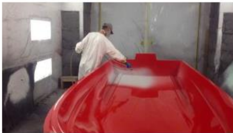
Figura 5. Aplicación del topcoat – Fuente: www.navalcomposites.com
